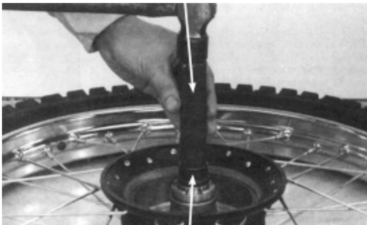
INSTALADOR DO ROLAMENTO (32 X 35 mm) GUIA DO ROLAMENTO 15 mm
