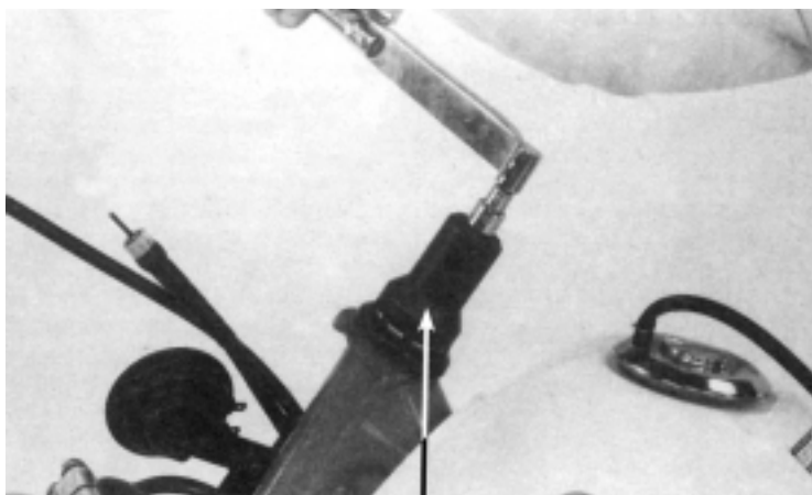
CHAVE SOQUETE DA COLUNA DE DIREÇÃO (F.E. N.º 07916-3710100)
