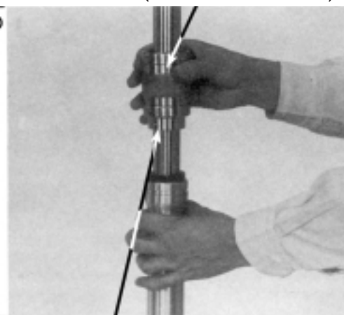
INSTALADOR DO RETENTOR (F.E. N.º 07947-KA20200)
